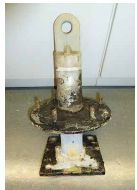
▲ Alter Anschlagpunkt nach dem Ausbau: Viele dieser Bauteile sind nicht mehr sicher
